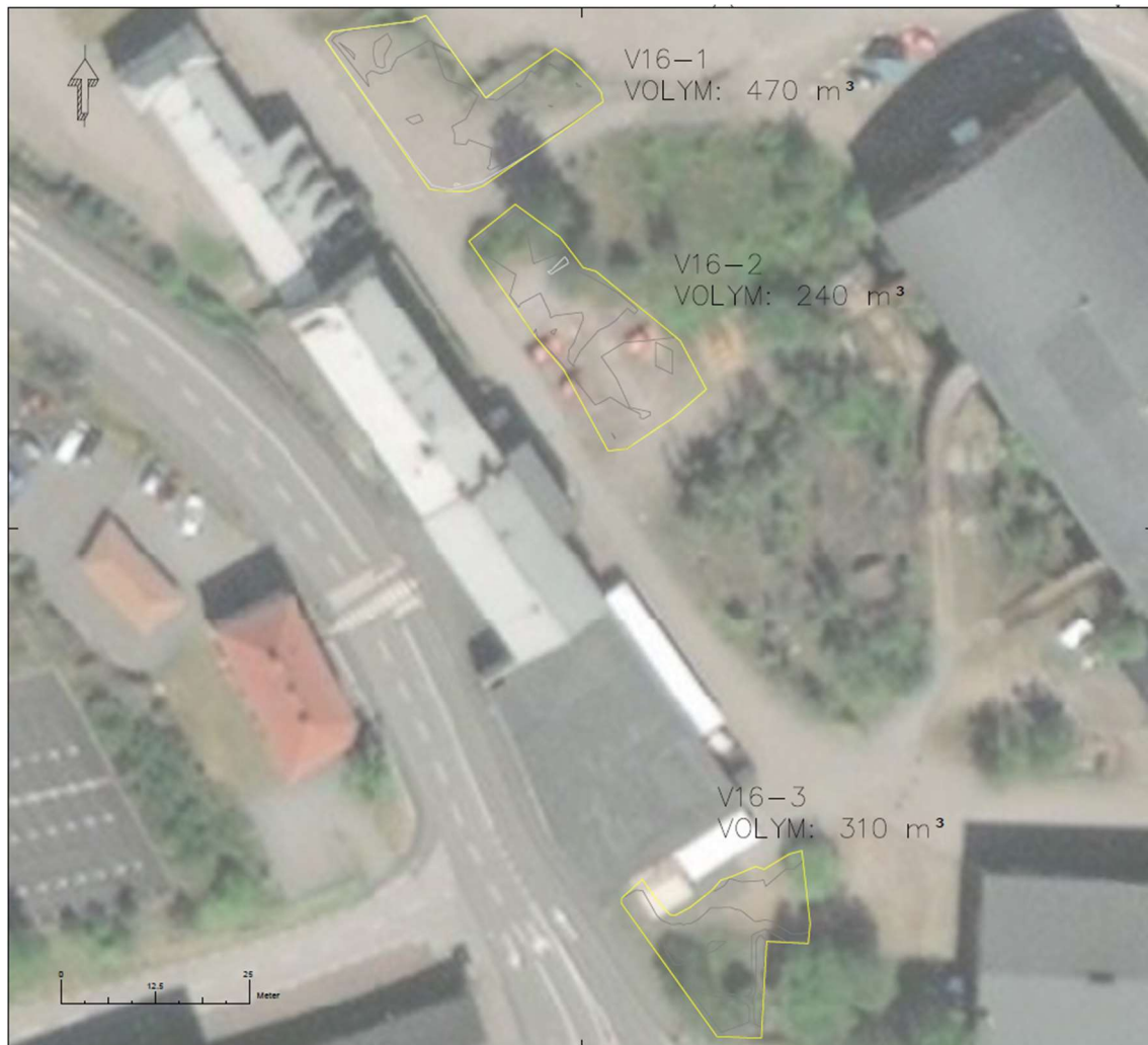
Figur 3. Ritning inmätt schakt/sanerade ytor.
